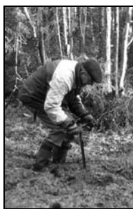
Figur 2. Bild på hur jordsonden är tänkt att användas.
